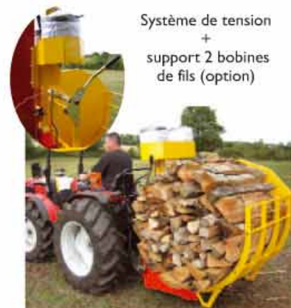
Fagoteuse de bûches sur 3 ème point tracteur (long. bûches 1 m => 1 stère)
