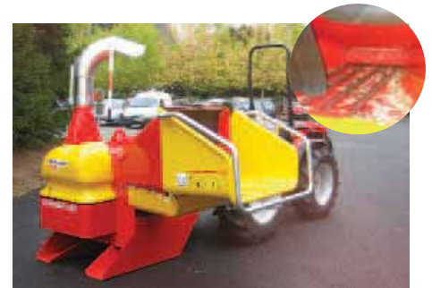
Broyeur de branches COPOMAT 160T avec tapis d'amenage
