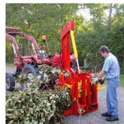
Compactage en actionnant la commande bimanuelle vers le bas
