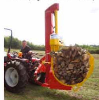
Fagoteuse de bûches sur fendeuse farmer II (long. bûches 1 m => 1 stère)
