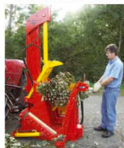
Relevage du fagot en actionnant la commande bimanuelle vers le haut
