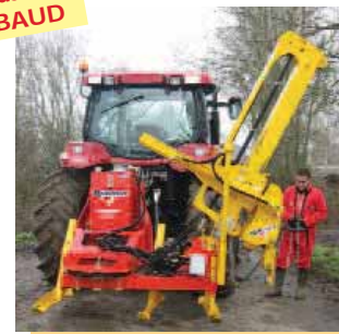
Réglage automatique de l'aplomb par inclinomètre.
