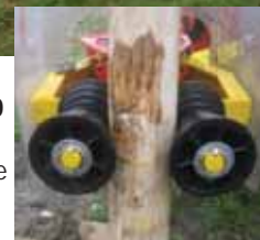
Enfonce-pieux TURBOFRAP 200 Attelage 3 points avec diabolos de série
