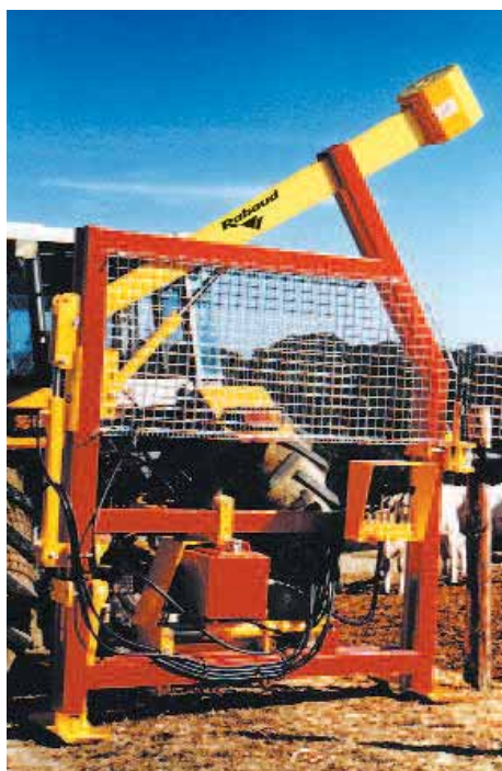
Enfonce-pieux par chocs Version éleveur avec options hydrauliques
