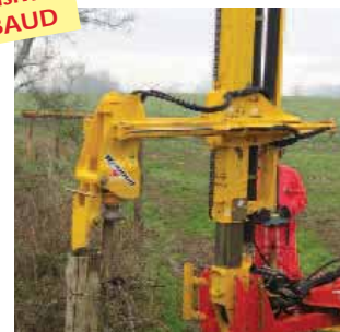
Déport hydraulique sur la tête du marteau pour un respect total de la végétation en place
