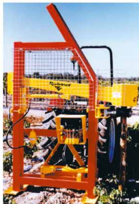
Enfonce-pieux par chocs version viticulteur 1,20 m avec options hydrauliques
