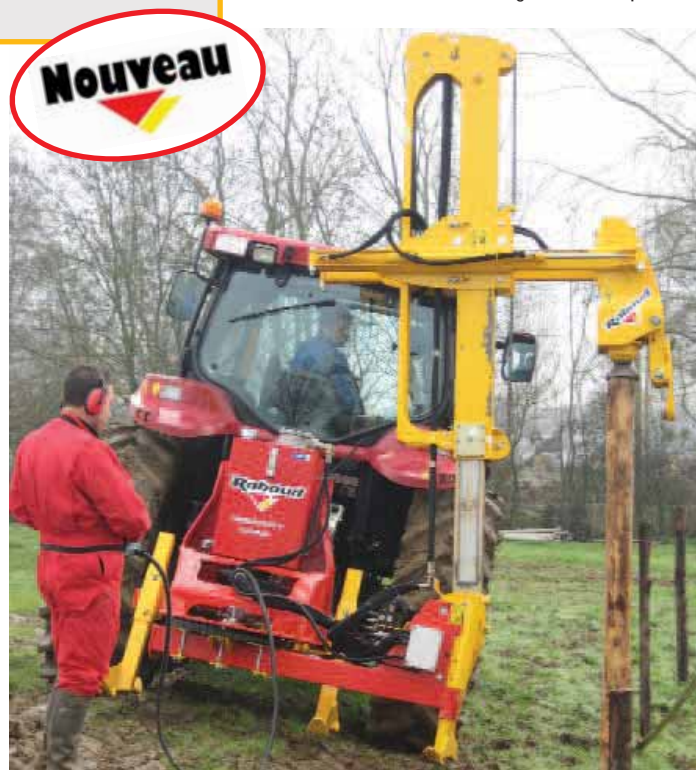
Déport hydraulique sur la tête du marteau pour un respect total de la végétation en place
