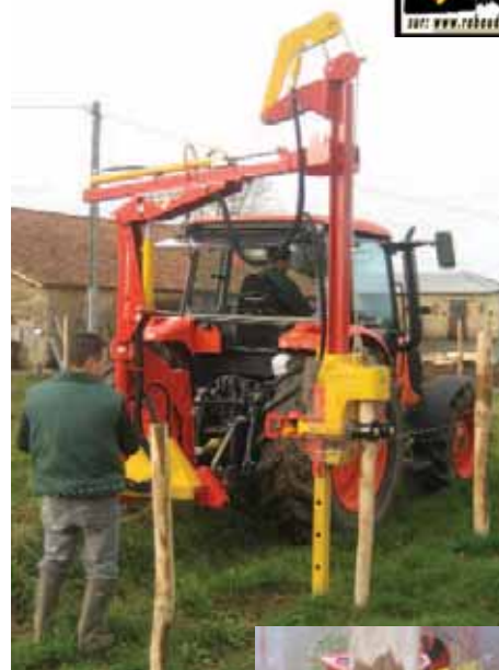
Enfonce-pieux TURBOFRAP 200 Attelage 3 points avec diabolos de série
