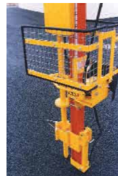
Pointerolle avec extraction hydraulique (exclusivité RABAUD)
