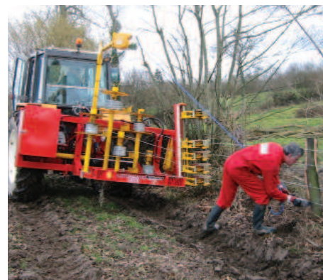
CLOTURMATIC 5 RXB avec correcteur de dévers au travail
