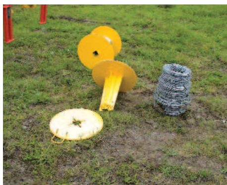
Bobines avec 1 flasque démontable sans clé (pour extraction fil). Ici barbelés après démontage d'une clôture
