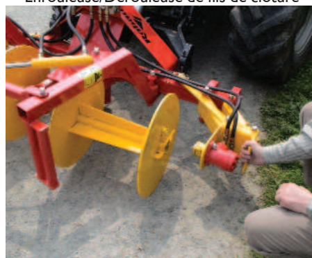
Changement et déchargement des bobines
